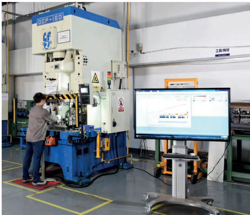
WERMA Smart-Monitoring im Retro-fit einer chinesischen Presse
